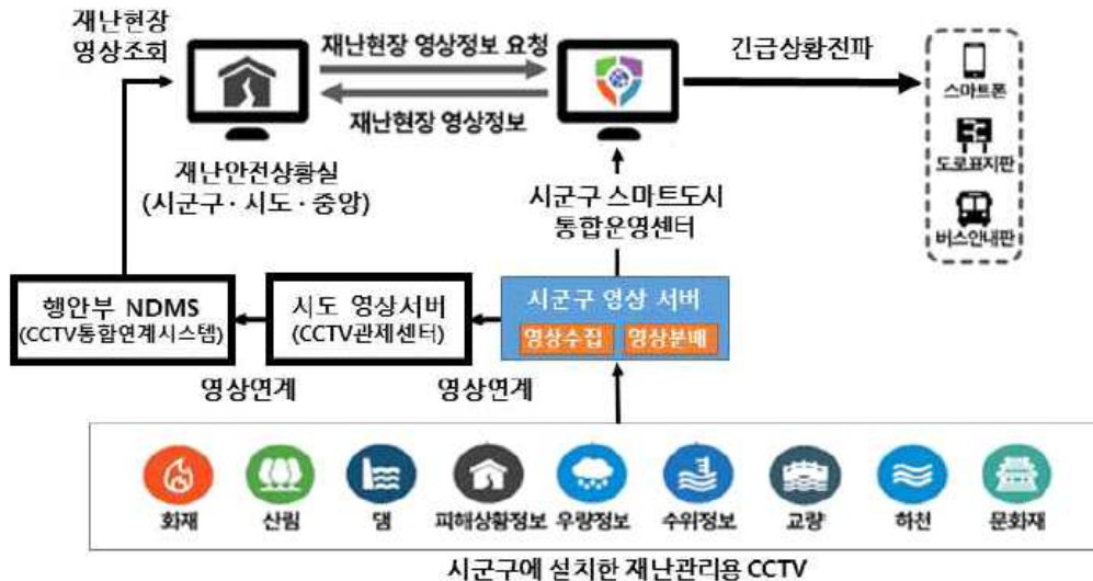
그림 24 국가안전시스템 종합대책의 CCTV 연계 체계도
